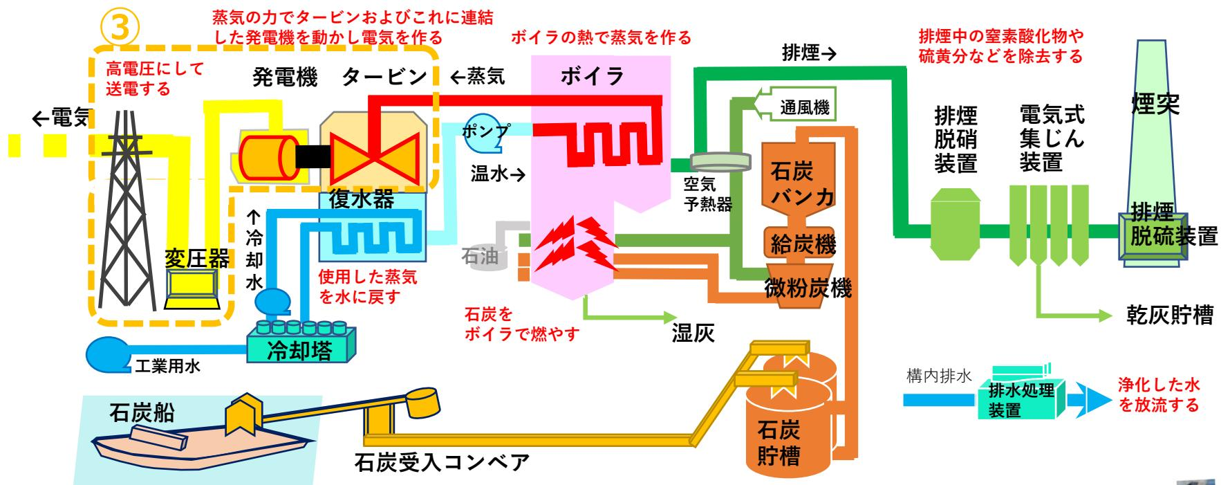
蒸気の力でタービン(羽根車)およびこれに連結した発電機を動かし電気を作っています。
