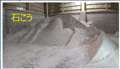
排煙脱硫装置は、排ガスから硫黄酸化物を取り除き、浄化するための装置です。当所では、煙突と排煙脱硫装置が一体型となっています。煙突の高さは80mです。湿式石灰石こう法で副産物として生成した石こうはセメント原料や建材原料(石こうボード)として、セメント会社等へ全量リサイクルしています。
